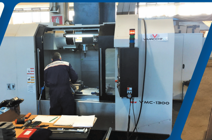
"MICROCUT" VMC-1300/40 BEARBEITUNGSZENTRUM Arbeitsbereich 1500 x 660 mm bei zulässiger Traglast bis 1200 kg
