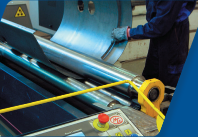
"MG" CNC-Kalander Arbeitslänge 2050 mm - 4 Kippwalzen
