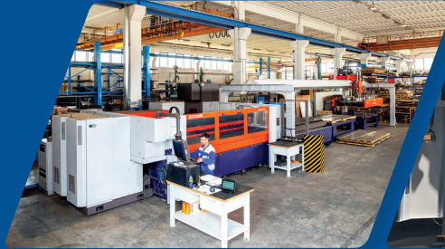
Laser Bystar 3015 4000 W maximale Resonatorleistung, Maximale Schnittstärke mm 20
